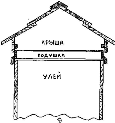
Рис. 72 а) рама для подушки с ящиком, в который ставится кормушка; б) подушка, в) втулка или подушечка для закрытия ящичка, г) подушка, надевающаяся на улей, д) улей с надевающейся подушкой и крышей в разрезе.
